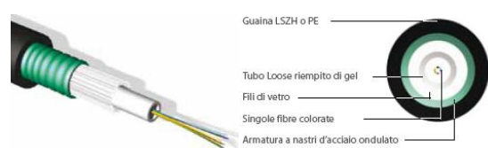
Cavo in fibra ottica armato da esterno
